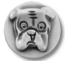
BAKELIT Das 1900 vom belgischen Chemiker Leo Baekeland entwickelte Bakelit ist ein Kunstharz. Es entsteht durch Kondensation von Formaldehyd und Phenol. Es hat die optischen Eigenschaften von Glas und ist einfärbbar. Bakelit war besonders in den 20er Jahren als Bernstein-Imitation sehr gefragt.
