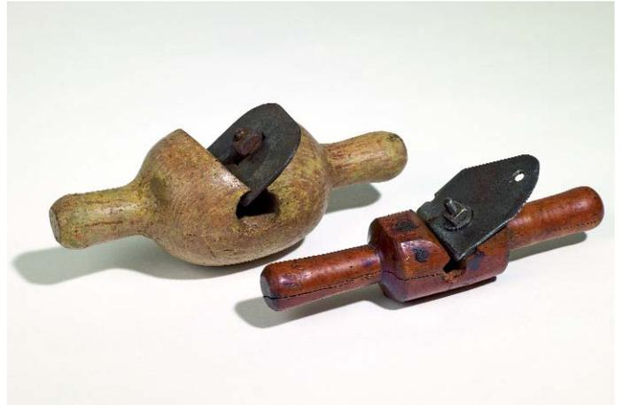
*Schaftshobel zur Schlägerherstellung, (shaftshaver od. trimmer), oberes Modell für Feinbearbeitung, vermutlich Birnenholz, unteres für Grobbearbeitung, Ulmenholz, angeschraubte Stahlklinge, 19 cm, bzw. 21 cm breit, angeblich aus der Werkstatt von Charles Gibson in Westward Ho.*
